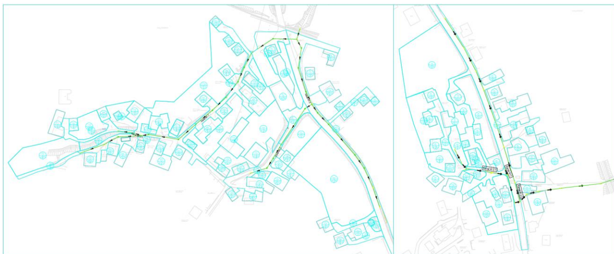
Slika 6: Upoštevane prispevne površine padavinskega kanala na območju obdelave Gorenje Ponikve (desna slika) in Dolenje Ponikve (leva slika)
